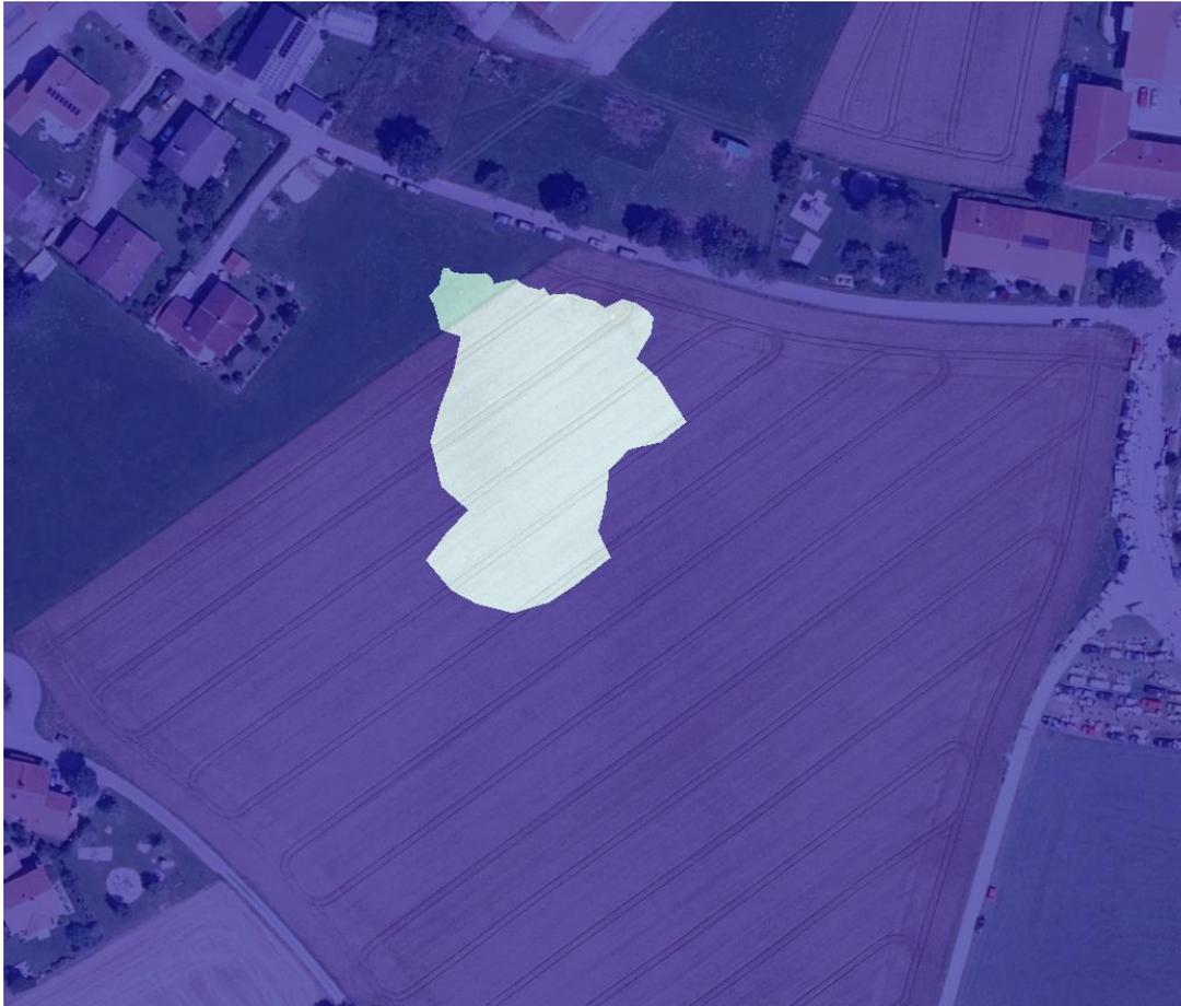
Umgriff Mulde, in dieser wurde eine Versickerung über den Oberboden mit einem Durchlässigkeitsbeiwert von  $k_f = 1,0 \cdot 10^{-6} \text{ m/s}$  angenommen
