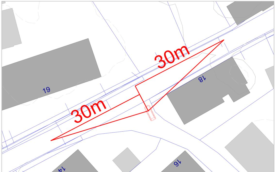
Abbildung 13: Prüfung der Sichtdreiecke (Anfahrtssicht) am Knotenpunkt K4 (30 km/h) [Hintergrund: Flurstückkarte Seon]
